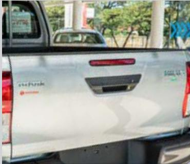
Tercera luz de freno integrada en tapa de carrocería.
