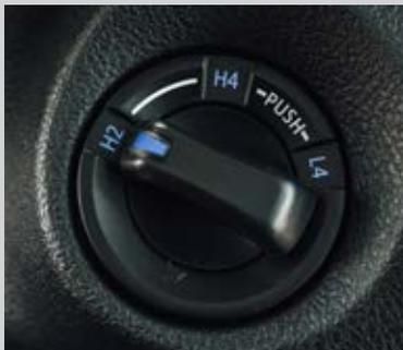
4x2, 4x4 y 4x4 reducida con accionamiento electrónico, ADD y A-TRC
