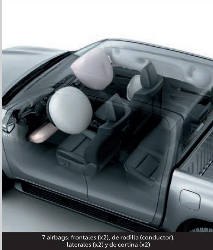
7 airbags: frontales (x2), de rodilla (conductor), laterales (x2) y de cortina (x2)
