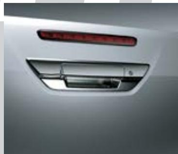
Tercera luz de freno LED integrada a la tapa de la carrocería
