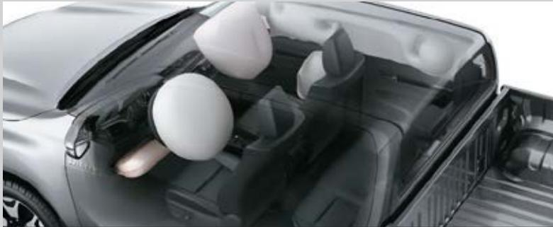
7 airbags: frontales (conductor y acompañante), de rodilla (conductor), laterales (x2) y de cortina (x2)
