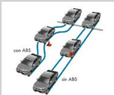
Frenos ABS con Asistente Electrónico de frenada (EBD) y Asistencia de frenado de emergencia (BA)
