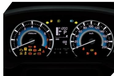
Tablero con doble esfera e indicadores en el centro, diseñado de manera intuitiva, para que el conductor obtenga los datos de forma rápida y sencilla.
